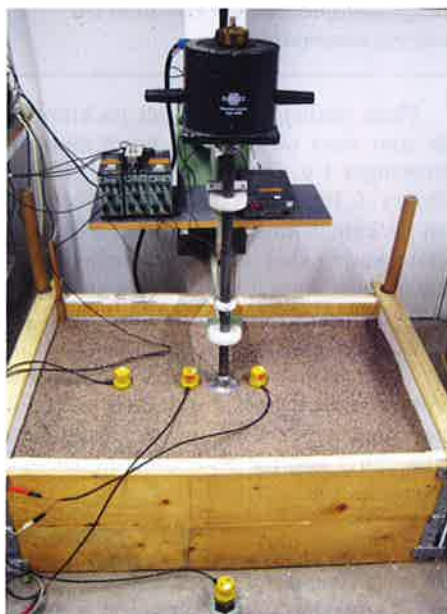
Figur 4: Småskaleförsök med torr sand. Mätning med accelerometrar, förskjutningsgivare, kraftgivare och geofoner.
