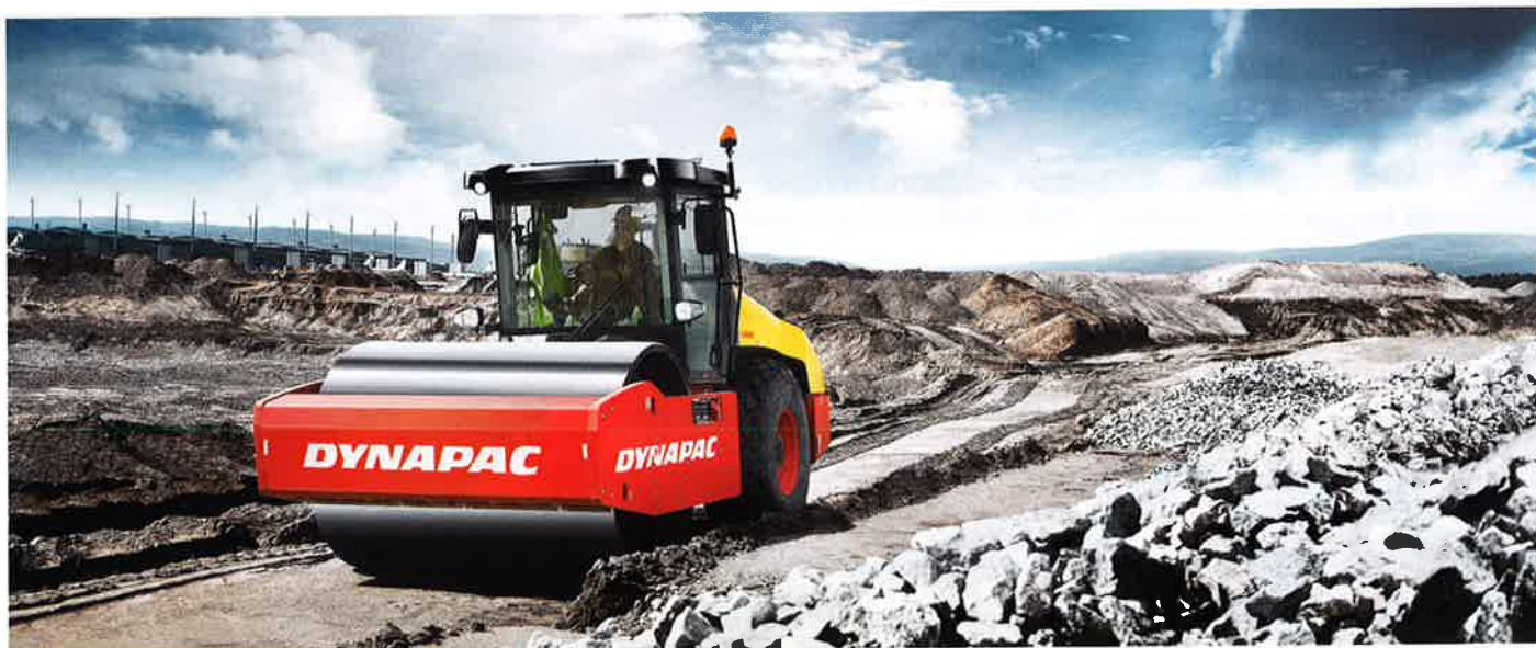
Figur 1: Dynapac CA6000 vibrovält med enkelvals för jordpackning.
